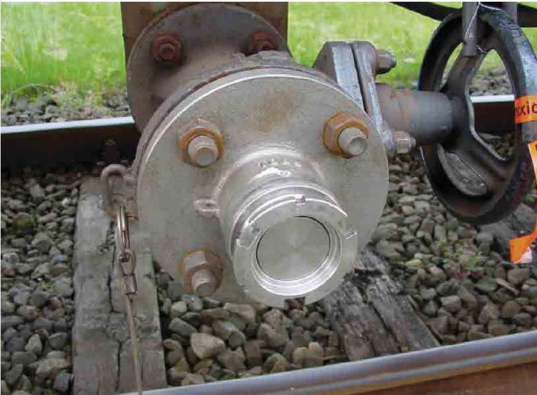
Fig. 3 Matériel de système de couplage avec déconnexion "à sec"
